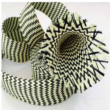
Rys.3. Rękaw z włókna węglowego (dwa kolory mają lepiej pokazać strukturę zwielokrotnionej podwójnej helisy rękawa bezszwowego)
